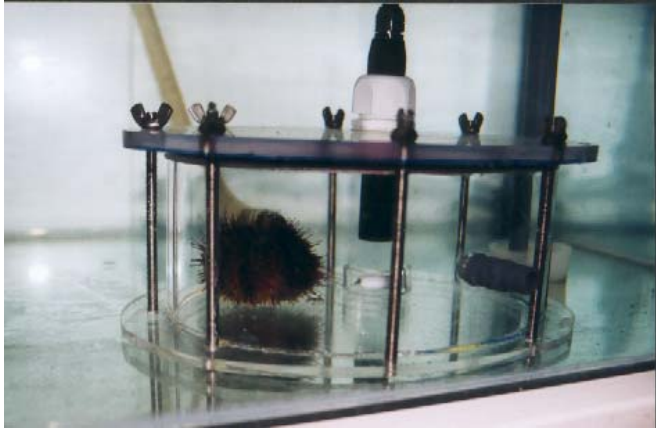
Bilde 2 Illustrasjon av respirasjonskammer bygget for måling av oksygenforbruk hos kråkeboller
