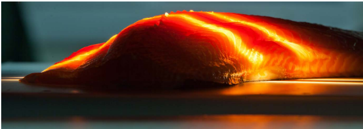
Figur 1 Interaktansoppsettet: Laksefilet med projiserte lyslinjer, der spektrografen registrerer hvor mye lys som kommer ut av fileten midt mellom lysstriperne.
