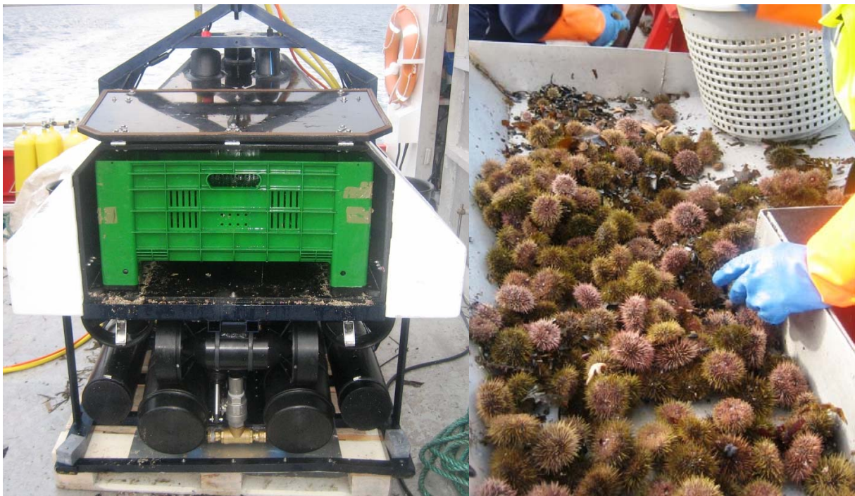
Figur 6 Til venstre: Oppsamlingskasse på Seabed Harvester. Til høyre: manuell sortering av kråkeboller om bord på "Scan Aqua"
