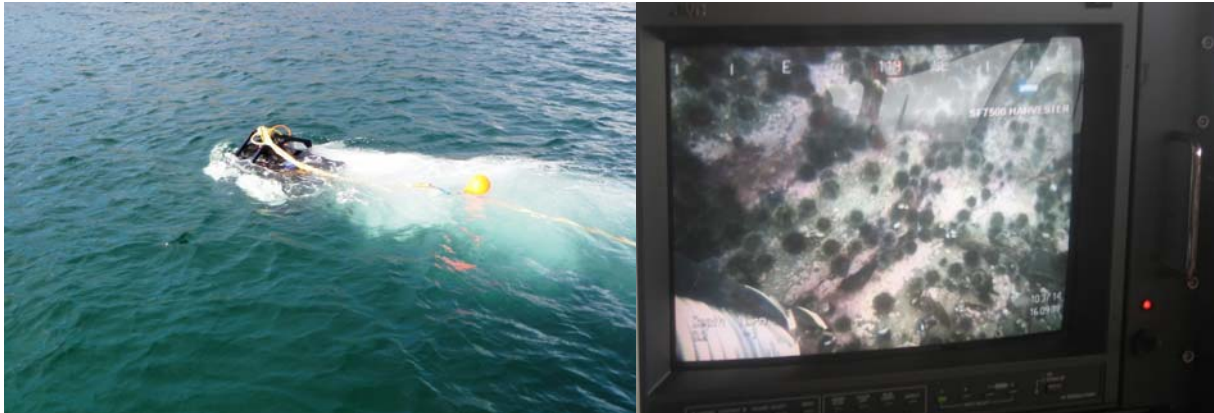
Figur 4 Til venstre: ROV i overflatestilling på vei til fangstområde. Til høyre: Monitor som viser bilder fra ROVen. Innhøstingsslangen kan sees til venstre på monitoren
